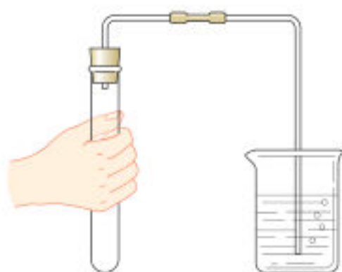
图 1-25 检查装置的气密性
