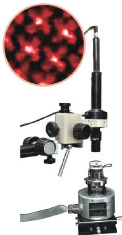
图6 扫描隧道显微镜及获得的某种有机物分子的图像
