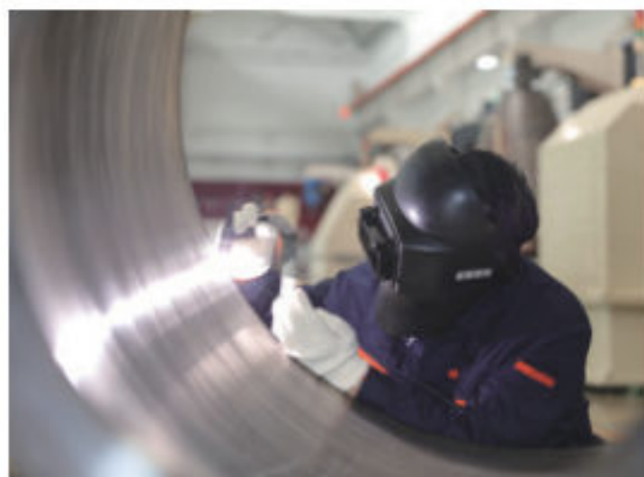
图8-8 我国工匠正在焊接火箭发动机喷管
