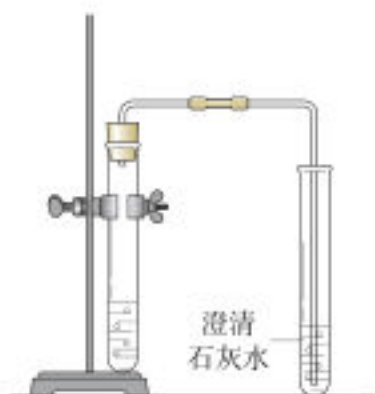
图 10-19 碳酸钠与稀盐酸反应的装置
