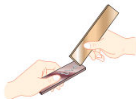
图8-3 比较合金和纯金属的硬度
