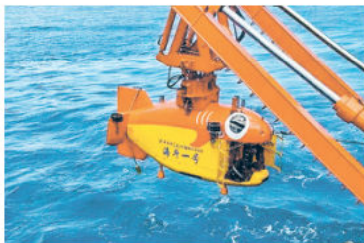
图 4-28 “海斗一号”全海深自主遥控潜水器
