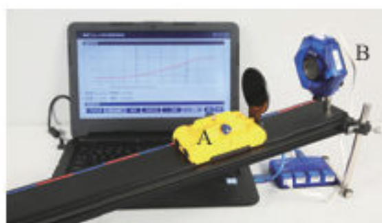
图1.4-3 利用传感器测量物体运动的速度
