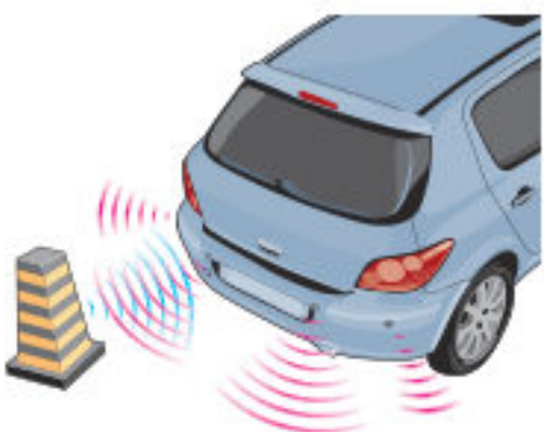
图2.3-4 利用超声波定位的倒车雷达
