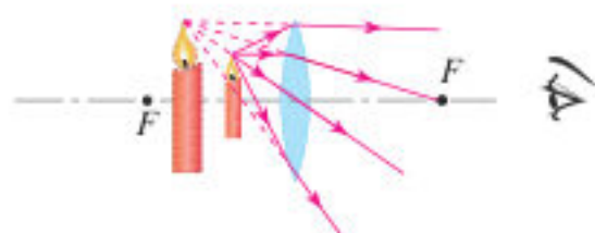
图5.2-8 凸透镜成虚像的情景
