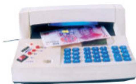
图4.5-7 紫外线使钞票上的荧光物质发光
