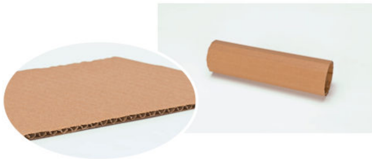
图5.5-6 利用瓦楞纸板制作镜筒
