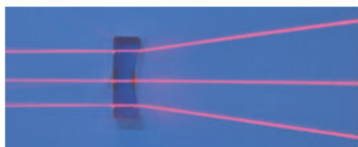
图5.1-6 凹透镜使光发散
