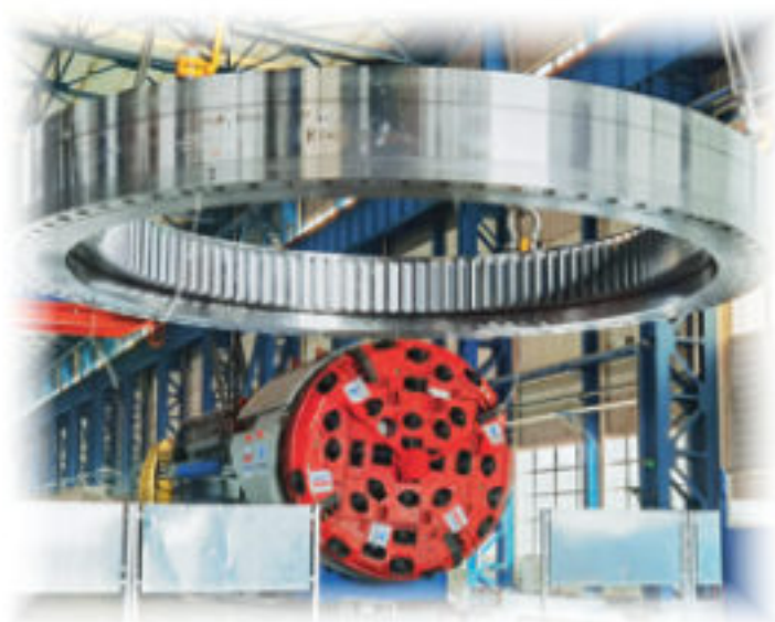
图8.3-8 我国自主研制的直径8 m的超大型盾构机主轴承
