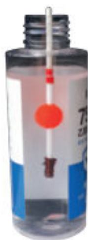
图10.4-6 用微型密度计测量小瓶酒精的密度
