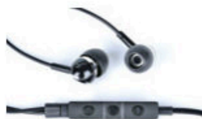
图16.4-6 利用数字电位器调节耳机音量
