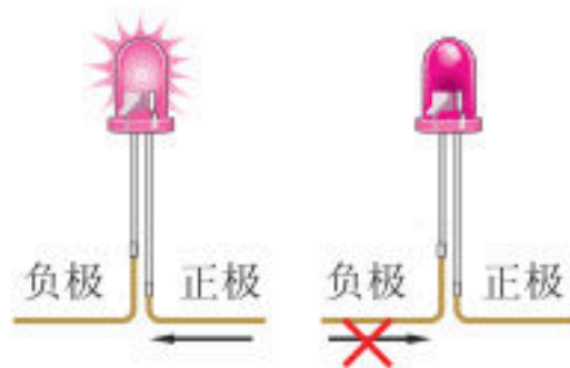
图15.2-4 发光二极管具有单向导电性
