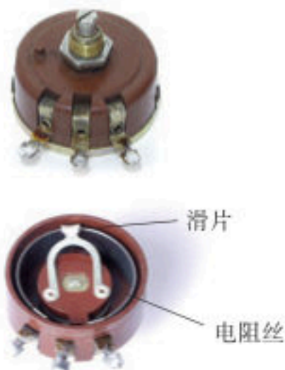
图16.4-5 一种电位器的结构
