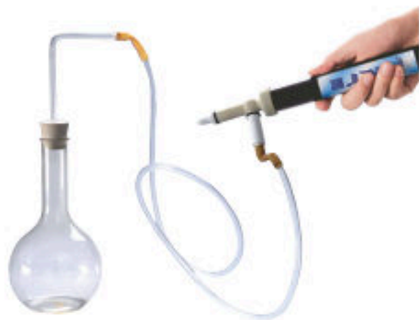
乙 空气推动瓶塞时内能减少
