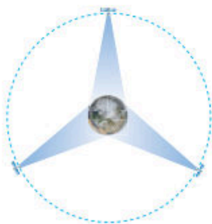
图21.3-4 用3颗地球静止卫星就可以实现全球通信
