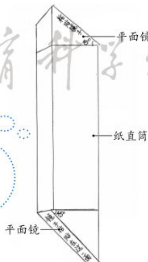
③ 在封口端分别裁剪出两个合适的插口，安装并调试平面镜的摆放角度。
